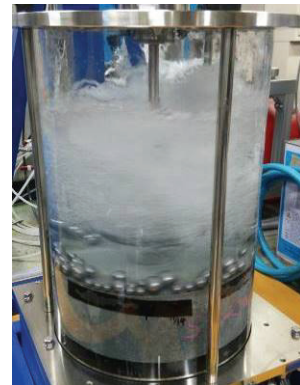
写真-6 流体エロージョン試験
