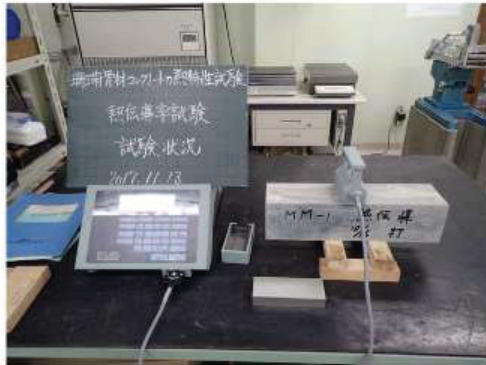
写真-5 熱伝導率の測定状況
